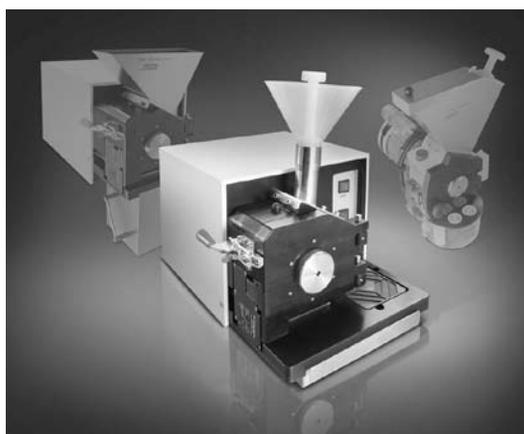
équivalent pour le broyage d'échantillons fibreux, collants ou visqueux, de matériaux plastiques ou de mélanges hétérogènes, ou encore pour la préparation d'échantillons en vue d'analyses de composition dans le secteur du traitement et du recyclage des déchets urbains et industriels.
