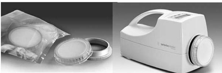
L'AirPort MD8 de Sartorius Stedim Biotech repose sur la méthode des filtres à membrane gélatine qui garantit des résultats fiables et précis. L'excellente rétention des microorganismes et des virus fait partie des nombreux avantages du collecteur de germes en suspension dans l'air AirPort MD8. Les microorganismes collectés peuvent être cultivés sur divers milieux nutritifs. La solubilité dans l'eau des filtres gélatine ouvre la voie à de
